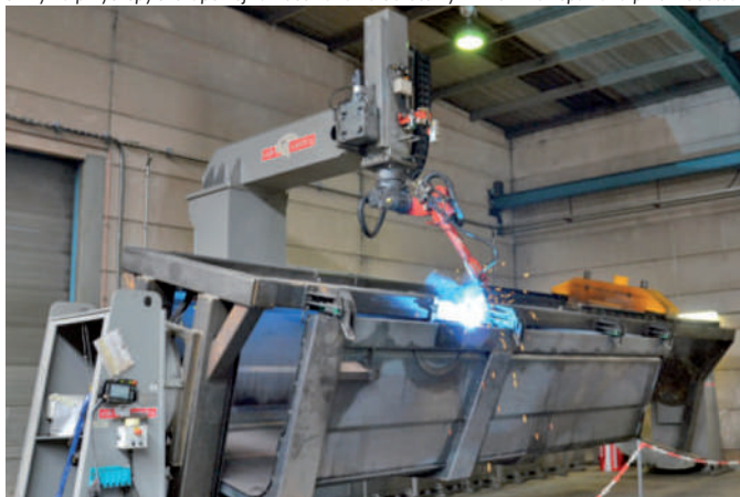
Skrzynia przyczepy skorupowej zamocowana na obrotowym wzorniku i spawana przez robota.
