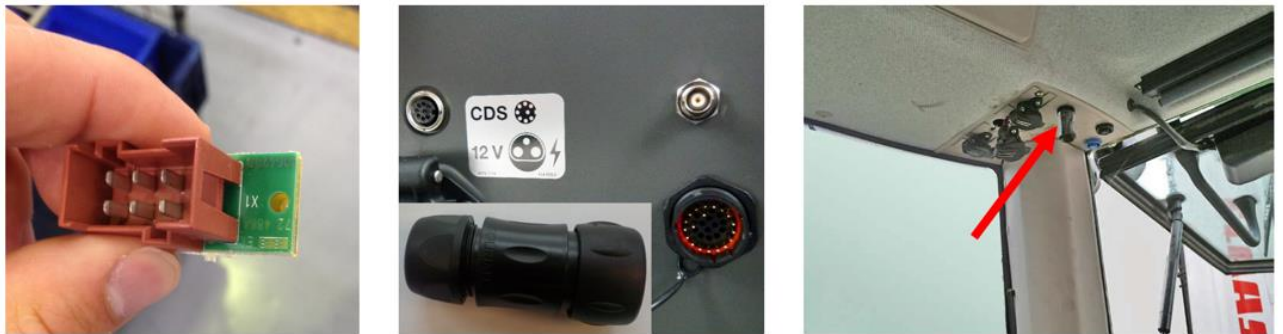
Ryc. 10. Przykłady wtyczek/mostków stosowanych w instalacjach magistrali Can-Bus
