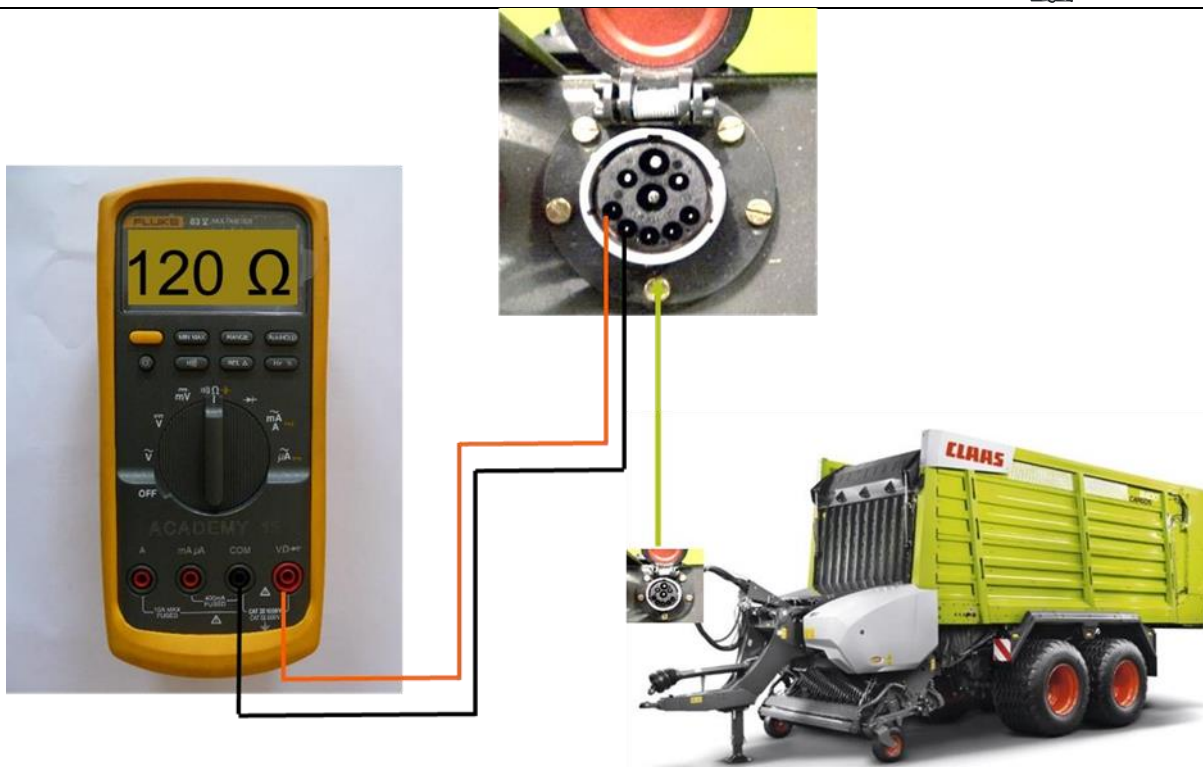
Ryc. 24. Pomiar rezystancji w gnieździe maszyny
