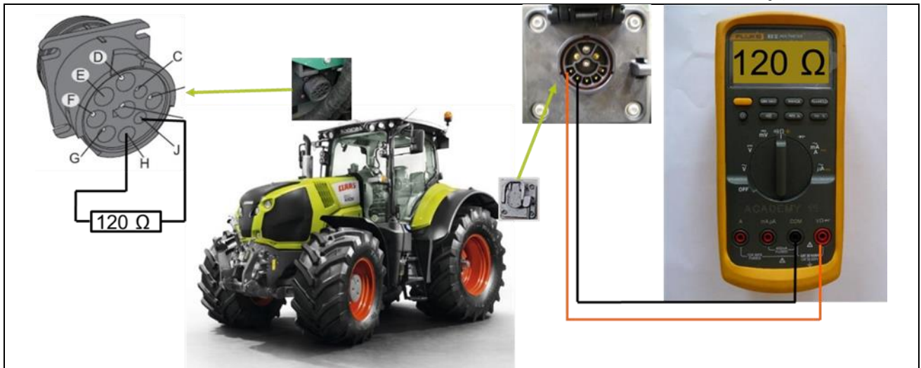
Ryc. 26. Pomiar rezystancji po podłączeniu dodatkowego rezystora 120 Ohm
