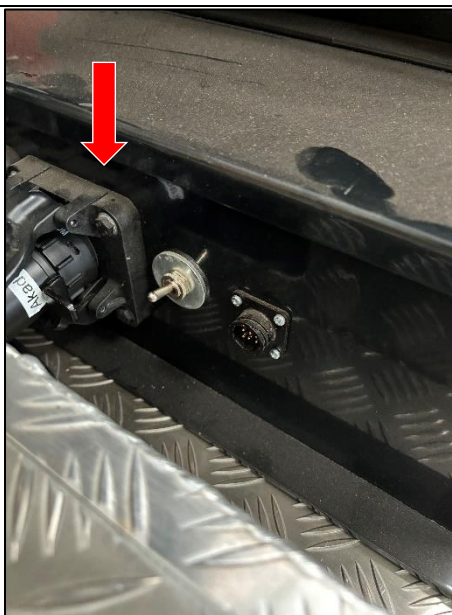
Ryc. 37. Połączenie wirtualnej maszyny z symulatorem ciągnika przez złącze ISO-BUS.
