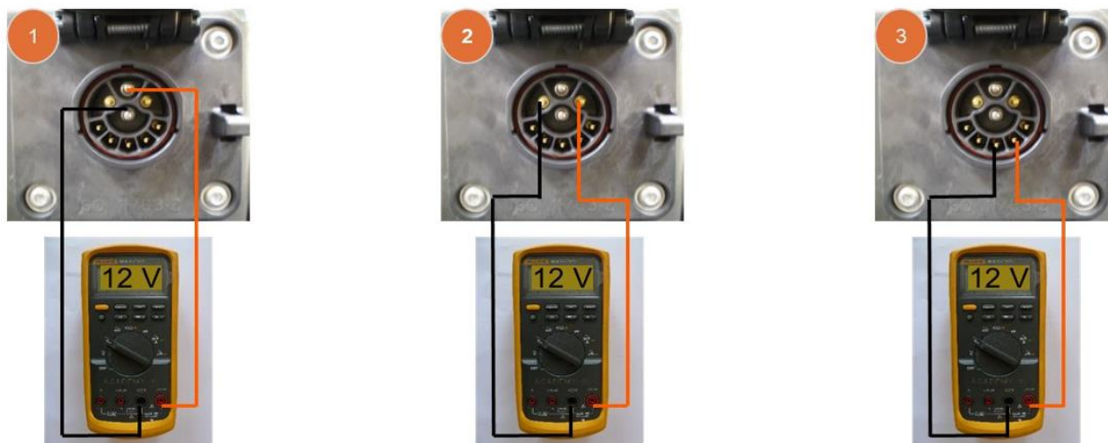
Ryc. 20. Sprawdzenie poprawnych napięć zasilania w gnieździe ISOBUS
