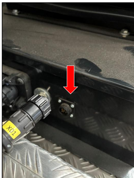
Ryc. 38. Podłączenie oraz uniwersalnego joysticka do symulatora ciągnika.
