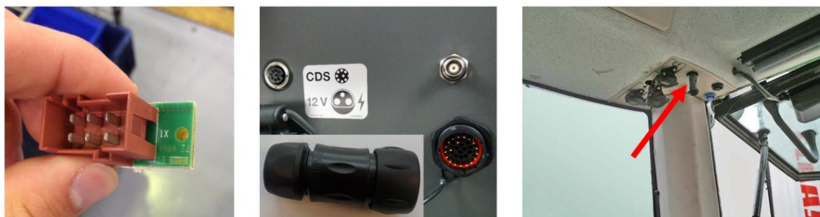
Rysunek 9. Przykłady wtyczek/mostków stosowanych w instalacjach magistrali Can-Bus.
