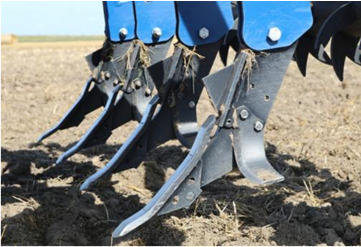
Pług dłutowy, z widocznym dłutom i podcinaczami.
