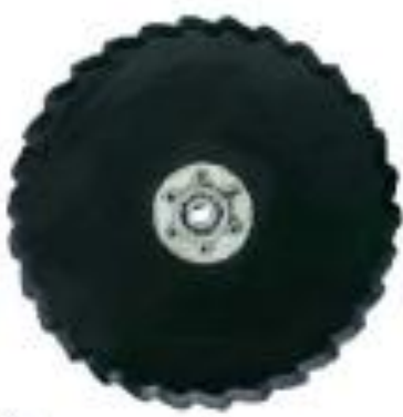
Zęby Redlice z ząbkowanymi ostrzami są bardzo skuteczne w cięciu pozostałości. Ząbkowana konstrukcja napędza obrót ostrza, co skutkuje mniejszym rozmazywaniem i lepszym pękaniem ścian bocznych.
