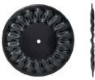
Bańka Redlice bańkowe otwierają szczelinę. Zapewniają doskonałą penetrację gleby i cięcie resztek poźniwnych, ale są zalecane tylko w glebach piaszczystych lub bardzo suchych glebach. Redlice te spowodują zagęszczenie ścian bocznych w ciężkich glebach gliniastych i ilastych.
