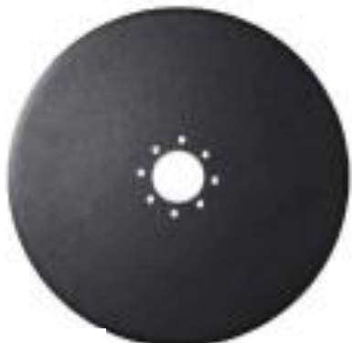
GŁADKIE REDLICE o gładkiej powierzchni i ostrej krawędzi są przeznaczone do cięcia ciężkich, twardych pozostałości. Są one jednak podatne na powstawanie smug na ścianach bocznych.
