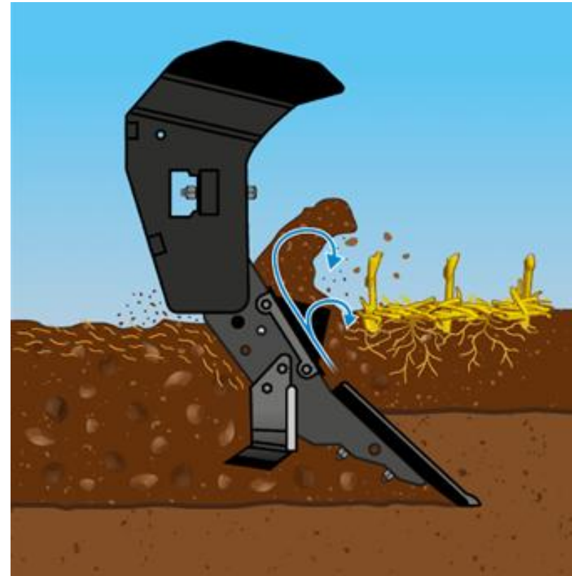
Zasada pracy pługa dłutowego podczas mieszania gleby.
