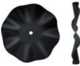
Falisty Pofalowane redlice tworzą duże kawałki gleby i często przeszkadzają w zamykaniu wykopu. Wymagają one również znacznie większego ciśnienia do działania.
